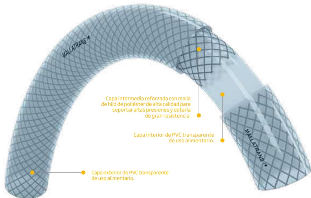
Capa intermedia reforzada con malla de hilo de poliéster de alta calidad para soportar altas presiones y dotarla de gran resistencia.
