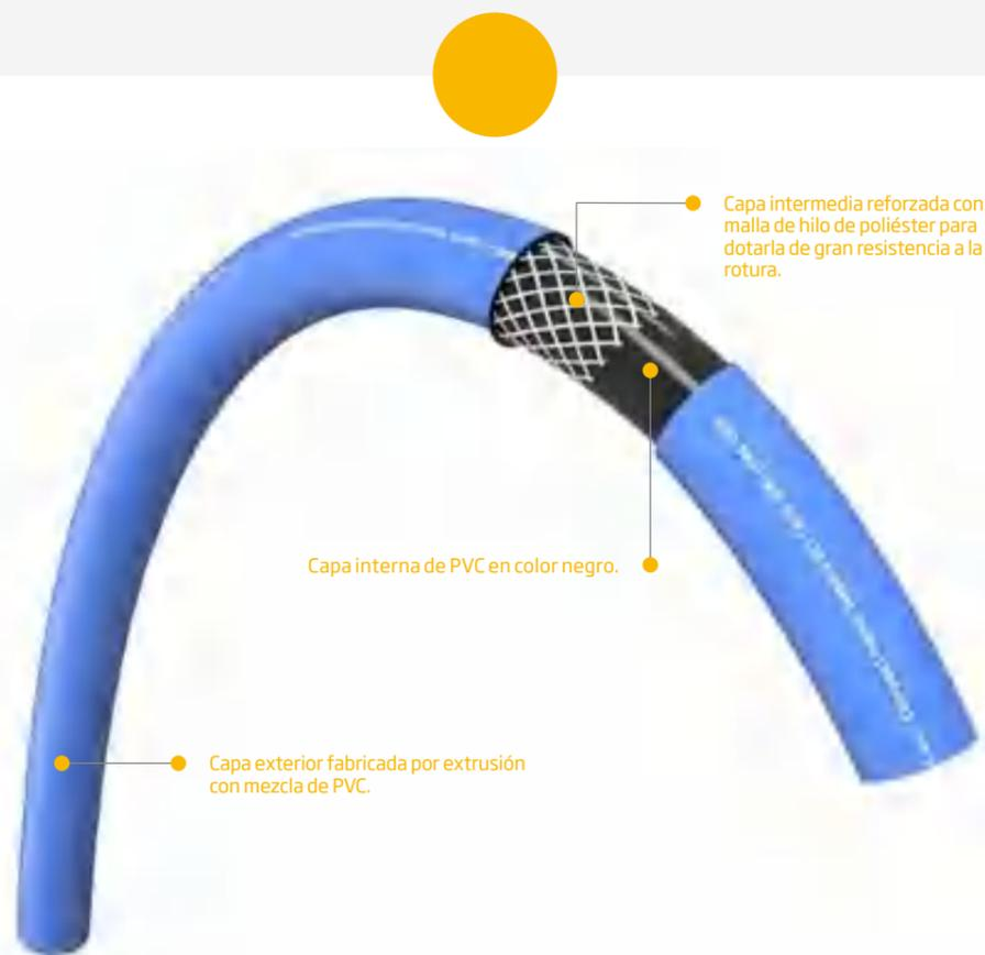
Capa intermedia reforzada con malla de hilo de poliéster para dotarla de gran resistencia a la rotura.
