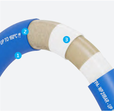
1.S - ALCOMIL 140°C + FDA W.P.O BAR. 2. EPDM azul - impresión lona, resistente al mal tiempo, al ozono y a la abrasión. 3. EPDM blanco liso alimentario, inodoro, reforzado con una doble espira metálica incrustada. Pliegues sintéticos de alta resistencia..
