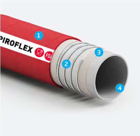
1.Lisa roja, impresión de tela. 2.Espiral de acero galvanizado. 3. Textiles sintéticos. 4. EPDM, Blanco.
