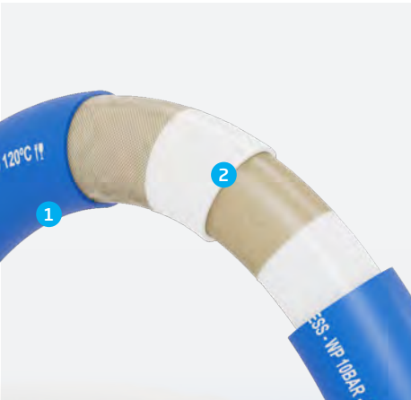
1.EPDM azul liso. 2.EPDM blanco liso, reforzado con pliegues sintéticos de alta resistencia.
